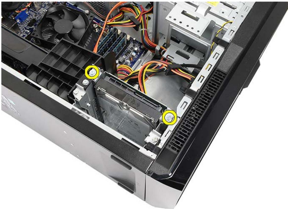
□□□ ドライブをコンピュータの側面に向かってスライドさせて、スロットから取り出します。
