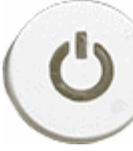
OFF     | コンピューターの電源が切れているか、またはコンピューターに電力が供給されていません。 | <ul style="list-style-type: none"> <li>電源ケーブルをコンピューター背面の電源コネクタとコンセントに取り付け直します。</li> <li>コンピューターが電源タップに接続されている場合、電源タップがコンセントに接続され、オンになっていることを確認します。また、電源保護装置、電源タップ、電源延長ケーブルなどを使用している場合は、それらを取り外してコンピューターに正しく電源が入るか確認します。</li> <li>電気スタンドなどの別の電化製品で試して、コンセントが機能しているか確認します。</li> </ul> |
