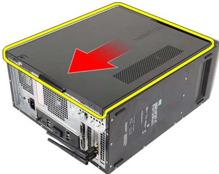
□□□ カバーを持ち上げてコンピューターから取り外します。
