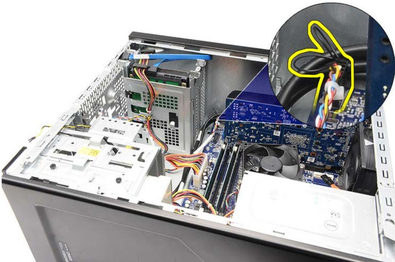
□□□ 電源ボタンケーブルを配線クリップから抜きます。
