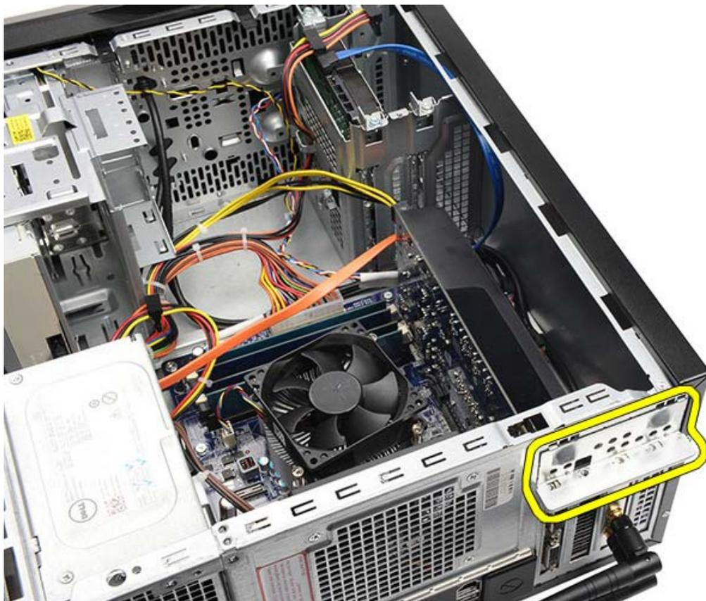
□□□ ビデオカードに接続しているケーブルを取り外します。
