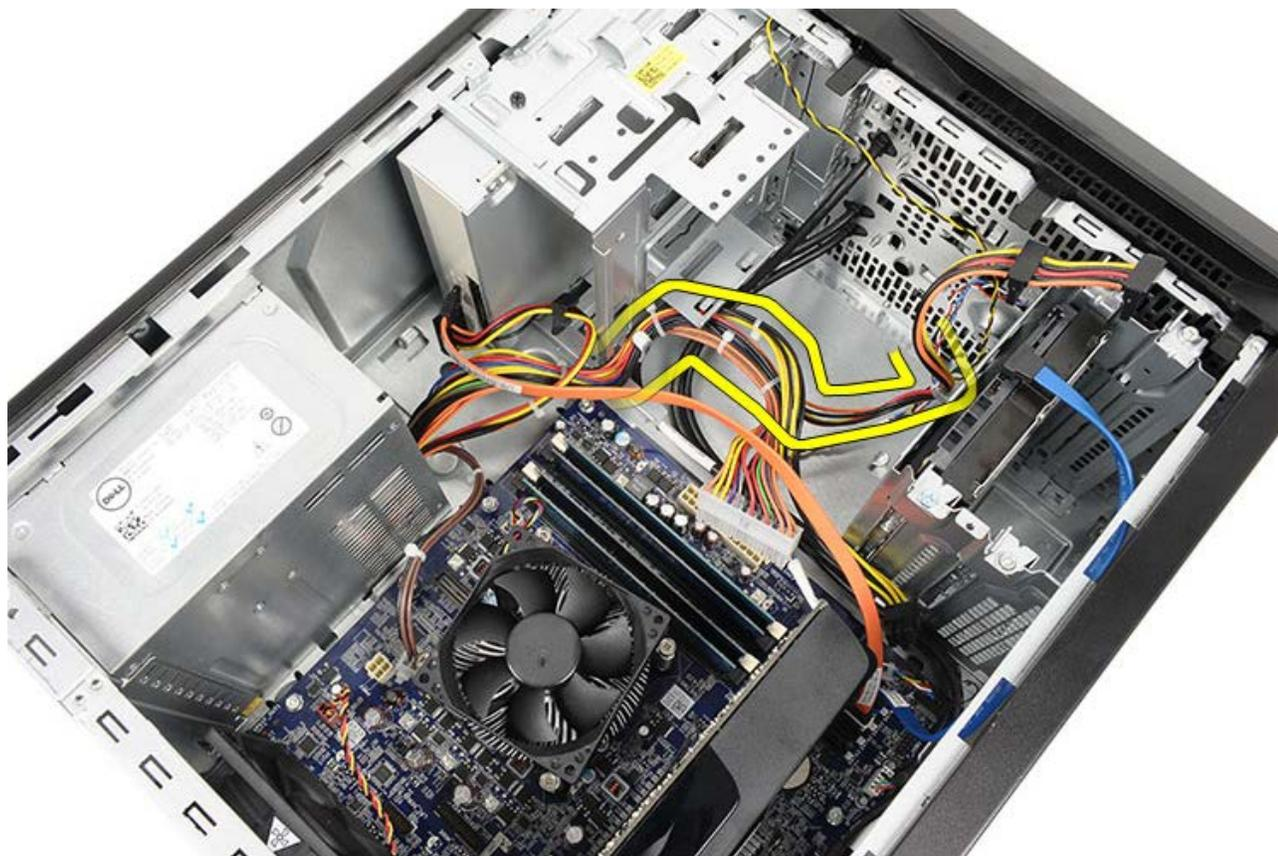
□□□ 電源ユニットをコンピューターに固定しているネジを取り外します。
