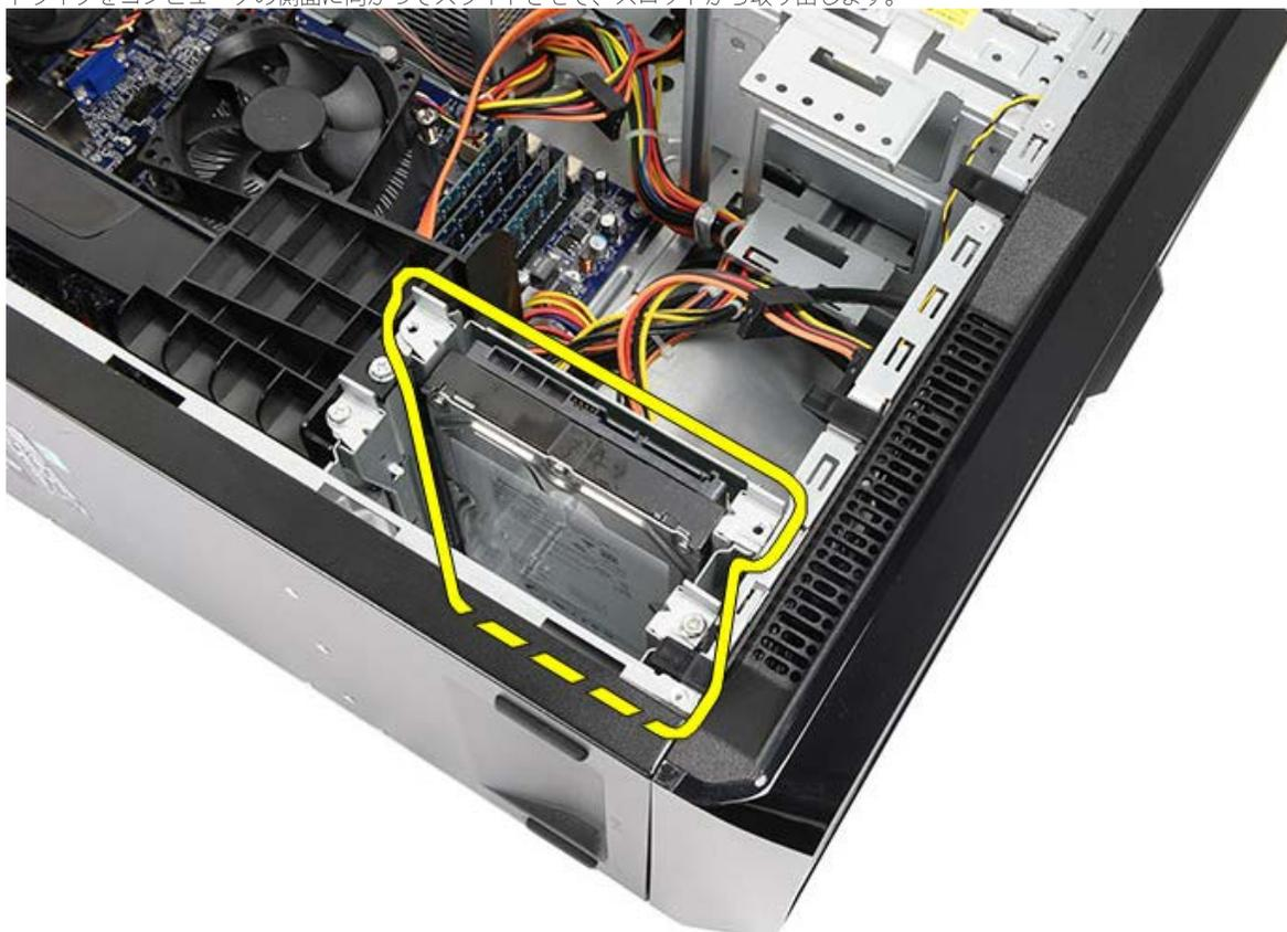
□□□ ハードドライブをドライブケースに固定している 2 本のネジを外します。
